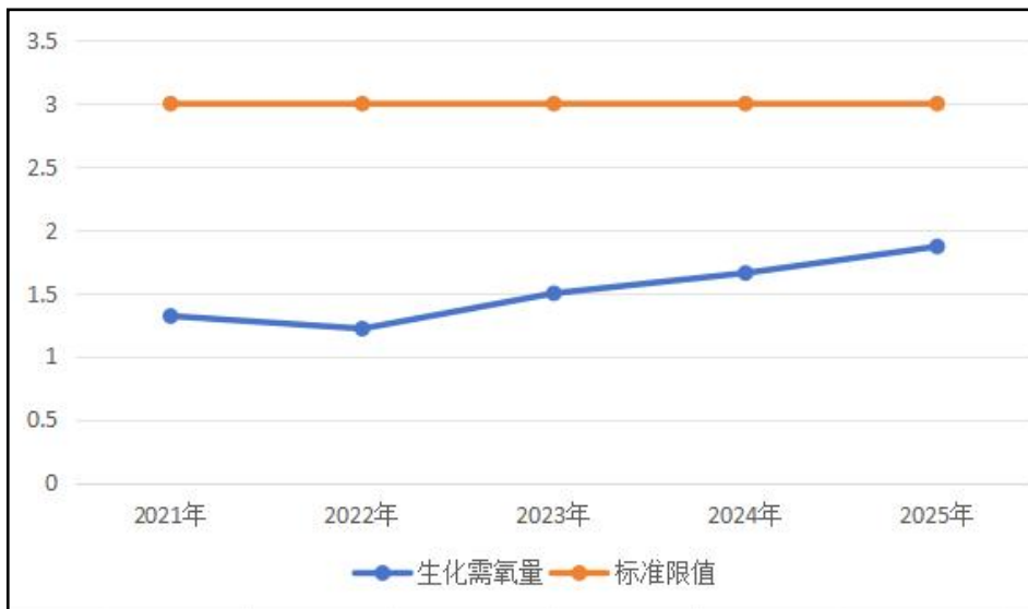
图3.5-26 黑水河（代家坝）监控断面生化需氧量质量变化趋势 单位：mg/L
